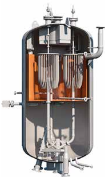
Doorsnede van een elektro-deboiler voor de productie van duurzame hoogwaardige stoom. (Foto Callens Vyncke)
